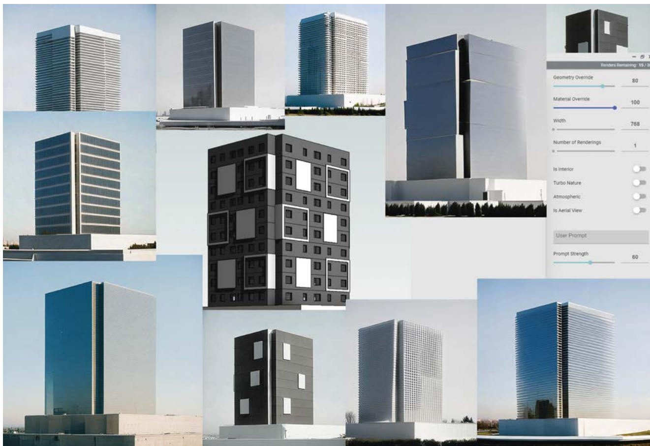
Veras to wspomaganą sztuczną inteligencją wtyczka do programów Sketchup, Revit i Rhino. Dzięki niej na podstawie modelu bryłowego, po wybraniu odpowiednich parametrów oraz wprowadzeniu opisu budynku, aplikacja kompiluje wizualizację.
