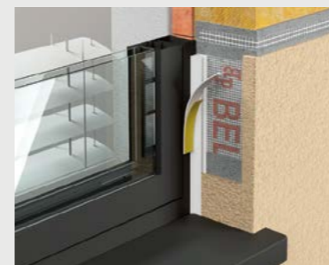
BP13 MIDI 9/3 – listwa przyokienna PVC dylatacyjna z siatką i uszczelką
