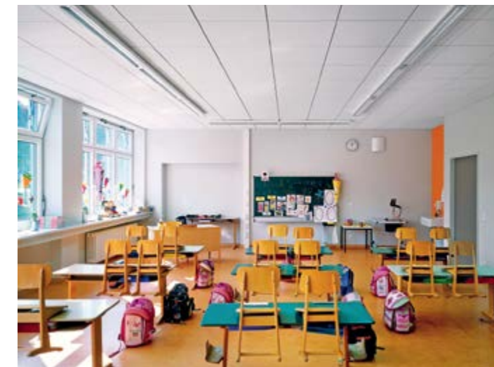
Modułowe, akustyczne sufity do klas wpływają na lepszą zrozumiałość mowy, mniejszy pogłos wewnątrz klas szkolnych, a także na izolacyjność akustyczną, czyli nie przepuszczają dźwięków pomiędzy sąsiadującymi pomieszczeniami.
